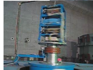
Usina de 3 Gargantas, China (IPT/Alstom/Voith) Cavitação em turbinas Francis (extensometria)
