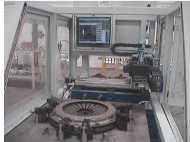
Máquina de testes de embreagem (Eaton China com parceria Lynx-ENGCC)
